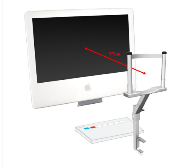
Figure 12 : Appareillage de l'expérience 1 comportant écran, reposoir, et pavé de réponse. Deux touches sont ici surlignées en couleur pour plus de visibilité, mais lors de l'expérience un autocollant "joie" et un "colère" étaient posés sur ces deux touches.
